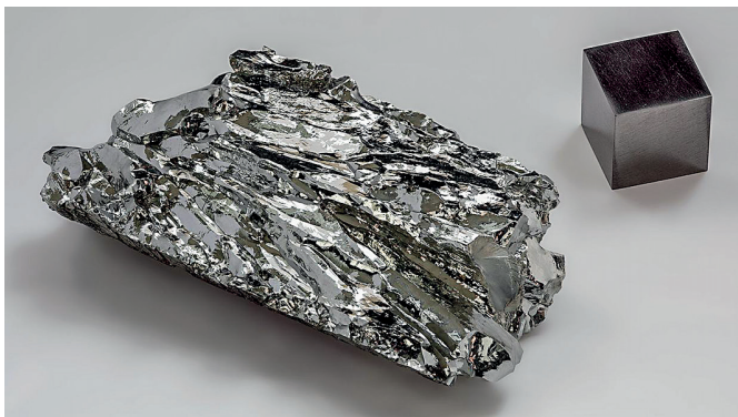
Afb. 2B. Puur polykristallijn molybdeen en een kubus van 1 cm 3 mono-kristallijn molybdeen. Foto: Via Wikipedia/pse-mendeleejew.de, Free Art License 1.3.
