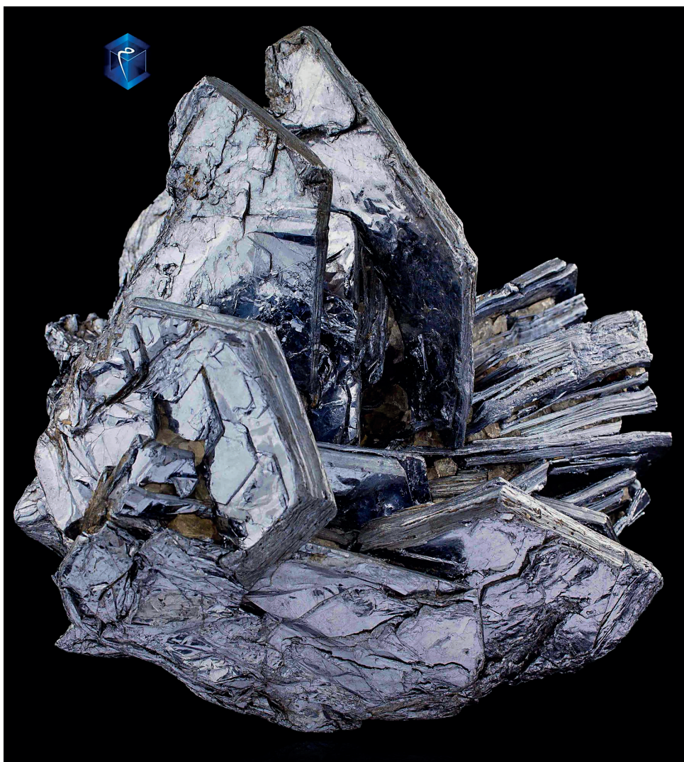
Afb. 2A. De belangrijkste bron van molybdeenproductie is het mineraal molybdeeniet, een molybdeen-sulfide ( MoS_2 ). Foto: MIM museum, FMI/James Elliott; AINU/Augustin de Valence; AINU/Alessandro Clemenza.
