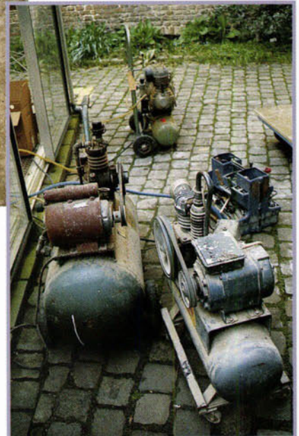
FIGUUR 4 Met drie gekoppelde compressoren raakt het gritstraalpistool niet buiten adem.
