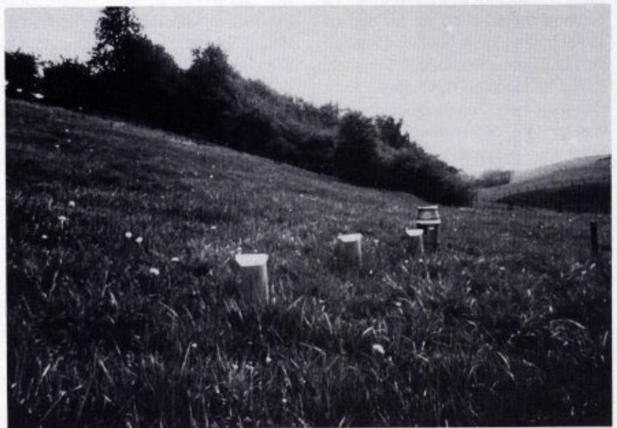
Figuur 1. Overzicht van het regenmeetstation aan de voet van de kalkgraslandhelling achter het Grachterbosje in het Gerendal (gem. Valkenburg). Vooraan zijn de 3 open regenvangers te zien. Daar achter staat de automatische regenschrijver voor het vervolgen van de regenval. (foto R. Bobbink).
