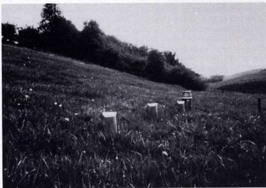
Figuur 1. Overzicht van het regenmeetstation aan de voet van de kalkgraslandhelling achter het Grachtbosje in het Gerendal (gem. Valkenburg). Vooraan zijn de 3 open regenvangers te zien. Daar achter staat de automatische regenschrijver voor het vervolgen van de regenval. (foto R. Bobbink).
