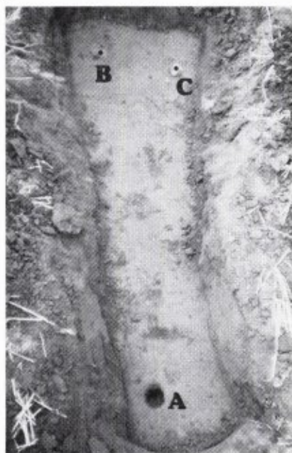
verstopt is. Pijp C blijkt ook dicht te zitten, zij het op iets grotere diepte.
