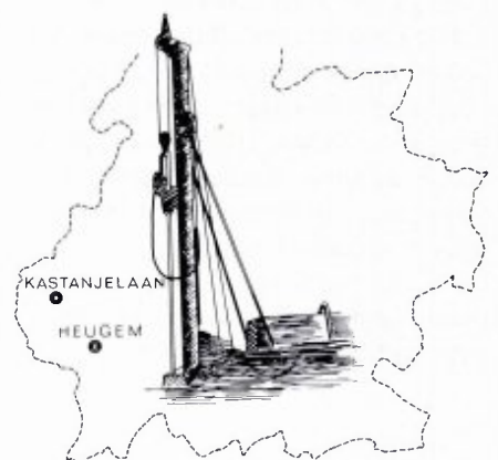
Figuur 1. Voor het afdiepen van de 500 m diepe boringen Heugem en Kastanjelaan in de gemeente Maastricht werd door de booronderne mer (de firma R. Gruner uit Sittard) een voor Nederland uniek boorsysteem toegepast: de "wireline". Deze oorspronkelijk in Frankrijk ontwikkelde methode wordt thans over de gehele wereld toegepast in de exploratie naar vaste delfstoffen, zoals steenkool en ertsen.
