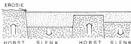
Figuur 3. Schematische voorstellingen van horsten en slenken en hun invloed op de dikte van het sediment-pekkel. Op de horsten vindt geen of vrijwel geen sedimentatie plaats (soms worden oudere sedimenten hier zelfs geërodeerd). De relatief snel dalende slenken worden gekenmerkt door een dik pakket afzettingen.
