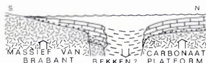
Figuur 11. Schematische doorsnede van Zuid-Nederland en Noord-België tijdens het Frasnien. Op de horsten werden dikke lagen van kalkige sedimenten afgezet, waarin vele rif-vormende organismen (korelen, kalk-algen e.d.) als fossielen zijn teruggevonden. Aan de basis van deze carbonaat-afzettingen vindt men vaak een basaal-conglomeraat, dat in hoofdzaak bestaat uit gerolde fragmenten van de onderliggende Cambro-Silurische gesteenten.
