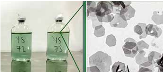
Afb. 5. Groene roest dat is ontstaan bij het laboratoriumonderzoek dat de omstandigheden in de vroege Precambrië oceanen nabootste. Foto: Weizmann Institute of Science (Rehovot, Israël).
