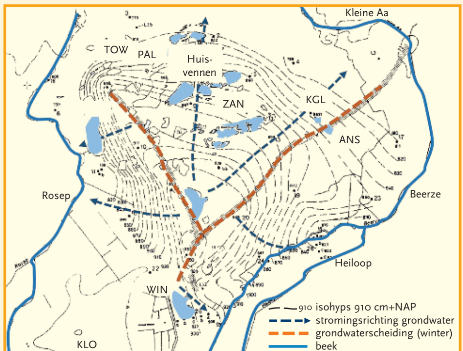
Fig. 2. Opbolling en radiale stroming van het grondwater in het zandpakket van de formatie van Baxtel vanuit de dekzandwelingen en uitgestoven laagten van de Kampina richting de beekdalen (bewerking van Roelofs & Vos, 1979).
