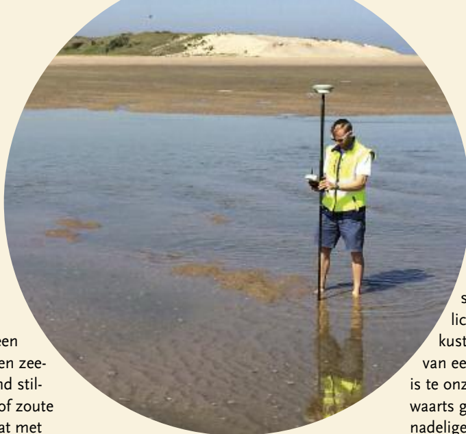
Foto 2. Meting RTK-GPS raai (bron: Agentschap voor Maritieme Dienstverlening en Kust, mei 2018).
