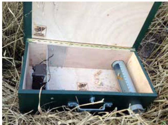
● De mostela is een speciale cameraval ontwikkeld voor het vastleggen van moeilijk te inventariseren kleine marterachtigen zoals wezel en hermelijn. Het is een kist waardoor een buis loopt die in de kist is opengemaakt. De camera in de kist kan zo de dieren die door de buis lopen vastleggen op film of foto. Foto: Carola van den Tempel.
