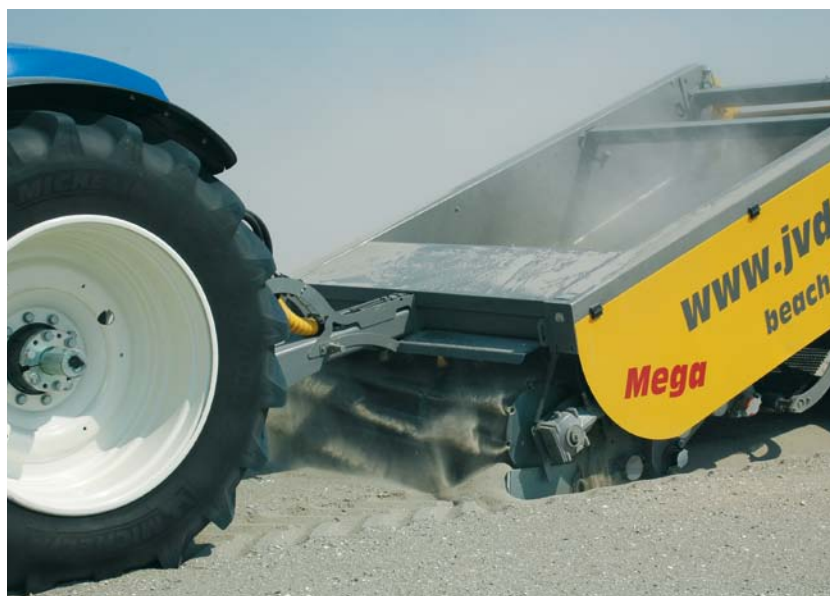
AFBEELDING 2. | Aan de voorkant van de MBC bevindt zich een ruim 2 m brede rol, die tot 15 cm diep het zand loswoelt en naar een zeef transporteert.
