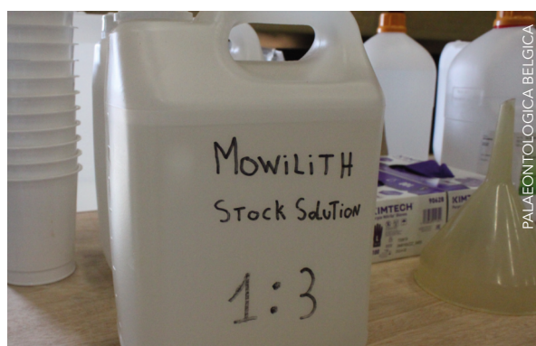
Figuur 21. Stock solution (basisoplossing) van Mowilith™ in de verhouding 1:3 wordt aangemaakt in dezelfde afsluitbare aceton containers.
