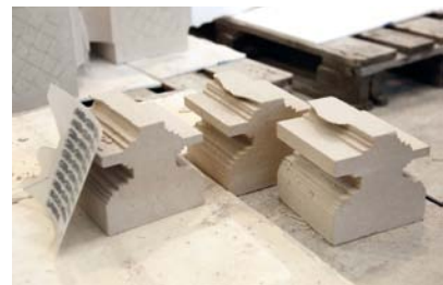
AFBEELDING 14. | Inzagen en ruimen van het overtollig materiaal rond de pironnen.
