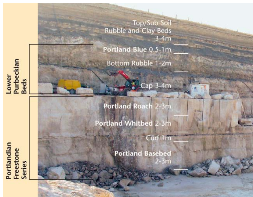
AFBEELDING 5. | Bowers groeve met indeling van de lagen binnen de Portland Freestone en de Lower Purbeck Beds. Foto: Albion Stone.
