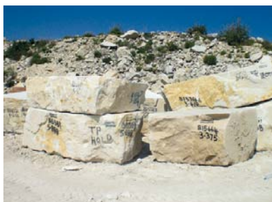
AFBEELDING 4. | Blokken Portland kalksteen waarop het volume en het groefleger met een dubbele streep is aangegeven.
