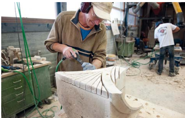
AFBEELDING 15. | Gebruik van de luchthamer.
