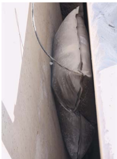
AFBEELDING 10. | Hydrobag waarmee het blok wordt gespleten. Foto: L. Gerdessen.
