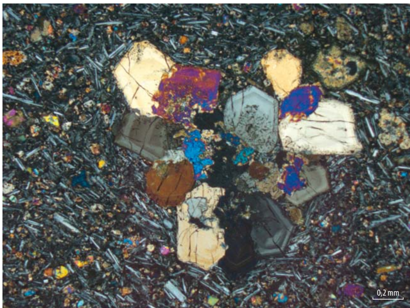
AFBEELDING 18. | Microfoto van basalt van de Weilberg met een aggregaat van amfibool in een grondmassa met onder meer talrijke microlieten van plagioklaas.
