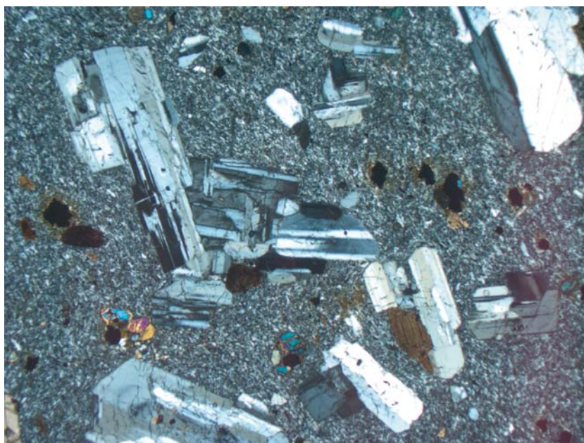
AFBEELDING 6. | Microfoto van Drachenfels trachiet met kleinere plagioklaasfenokristen en kristallen van biotiet, amfibool en ilmeniet in de fijnkorrelige matrix.
