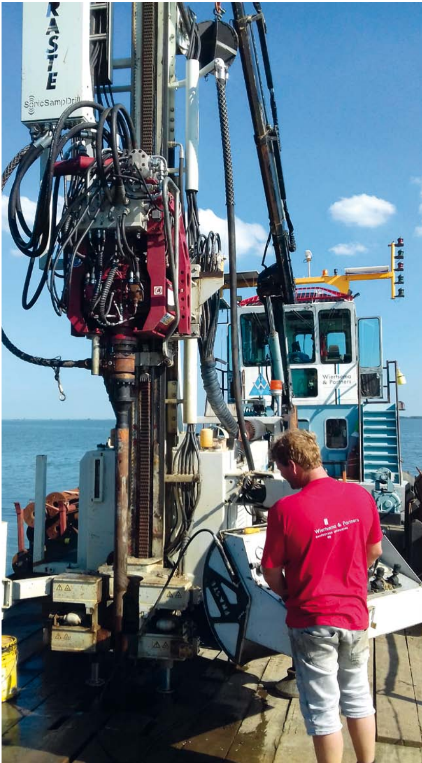
AFBEELDING 5. | Met een sonisch boorsysteem worden de continu gestoken boringen uitgevoerd. Foto: Robert van Lil, Periplus.
