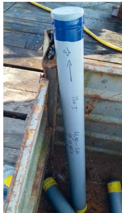
AFBEELDING 7. | De pvc-buis met het monster gereed voor transport naar het laboratorium. Foto: Robert van Lil, Periplus.
