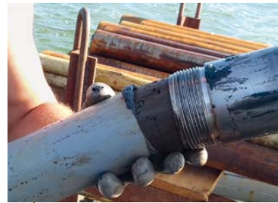
AFBEELDING 6. | Het gestoken monster wordt in de pvc-buis geduwd. Foto: Robert van Lil, Periplus.
