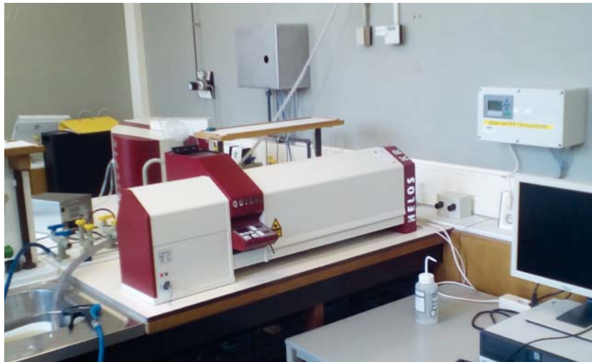
AFBEELDING 3. | De Helos Laser, die gebruikt wordt voor de korrelgrootte analyse (zie tekst).
