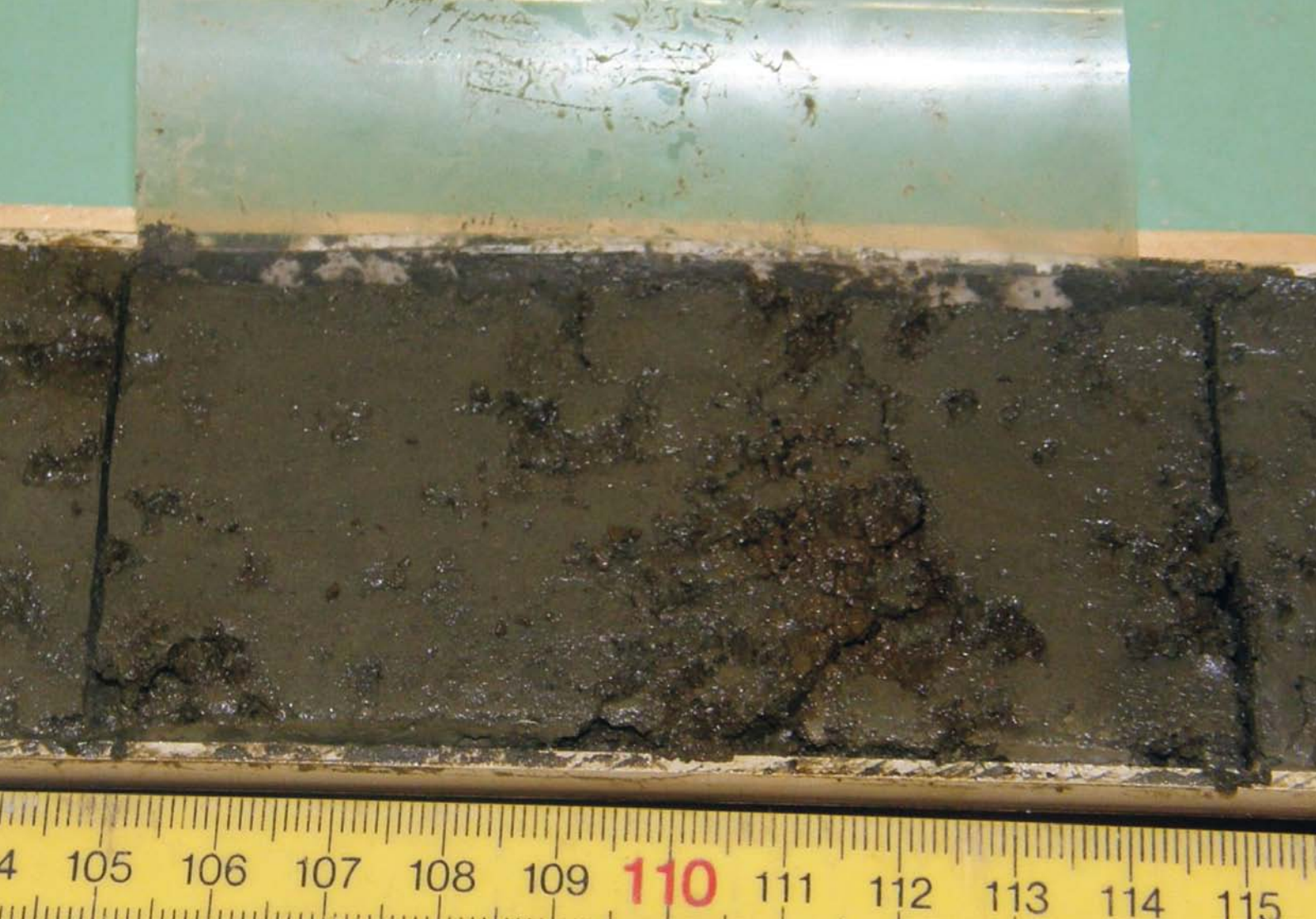
AFBEELDING 1. | Bemonsteren van een boorkern.
