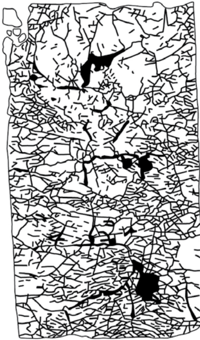
AFBEELDING 2. | Brokkenpatroon van twee slijpplaten uit de brokkelige klei. C.661 is 15 cm lang.
