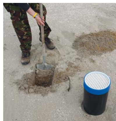
AFBEELDING 2. | Installatie van een zandvanger op de Zandmotor voor biogeochemisch onderzoek naar ecologisch getransporteerd zand.
