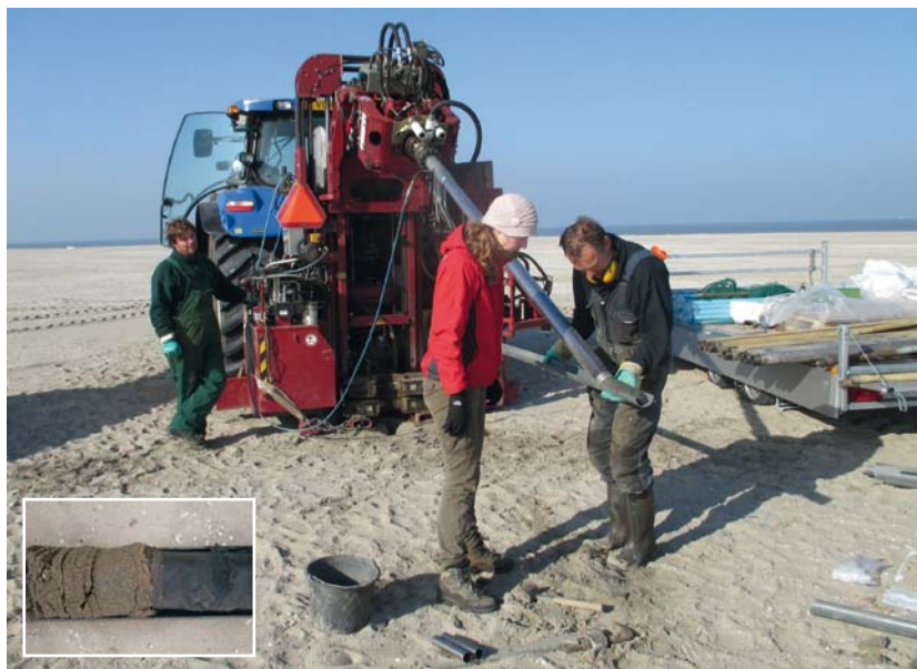
AFBEELDING 5. | Boren op de Zandmotor voor bemonstering van zand en grondwater.
