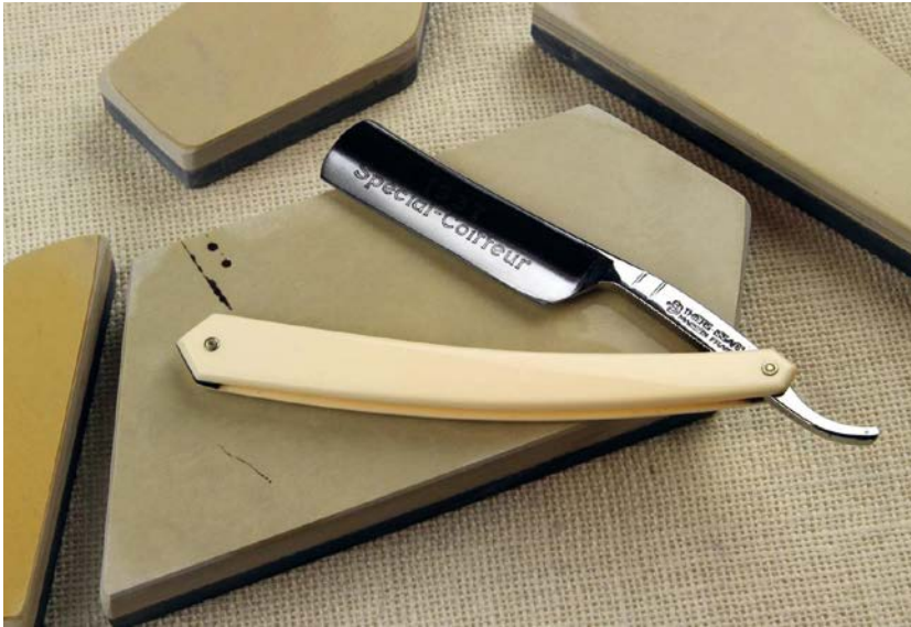
AFBEELDING 5. | Een heel bekend type wetsteen is coticule ofwel 'Belgisch brok'. Het is een veelgebruikt, tweekleurig gesteente dat gewonnen wordt in de Belgische Ardennen bij Vielsalm. Coticule is een bijzonder soort wetsteen door de aanwezigheid van uiterst kleine granaatjes. Granaat is harder dan kwarts. Met coticule worden bijvoorbeeld scheermessen vlijmscherp gehouden.
