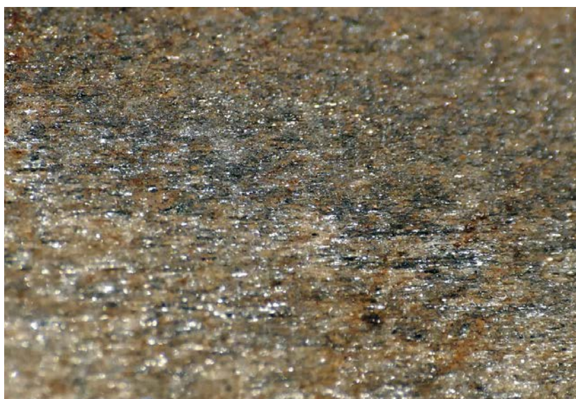
AFBEELDING 8. | Eidsborgkwartsiet, detailopname van het oppervlak. Het glinstereffect wordt veroorzaakt door zilverwitte blaadjes muscoviet. De hoekig gerekristalliseerde kwartskorrels breken of raken los uit het gesteente, waardoor het oppervlak van deze slijpstenen altijd scherp blijft. Dit verklaart het succes van Eidsborgkwartsiet door de eeuwen heen. De gerichtheid van de minerale bestanddelen is duidelijk zichtbaar. De bruine verkleuringen zijn secundair en worden veroorzaakt door roest.
