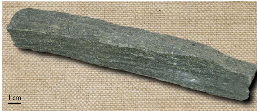
AFBEELDING 9. | Ruw gespleten en afgekorte slijpsteen van Eidsborgkwartsiet.
