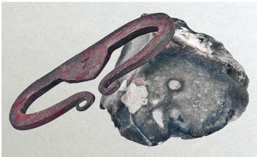
AFBEELDING 10. | Door met een vuurslag van koolstofstaal tegen vuursteen te slaan ontstaan vonken waarmee een vuurtje kon worden aangelegd.
