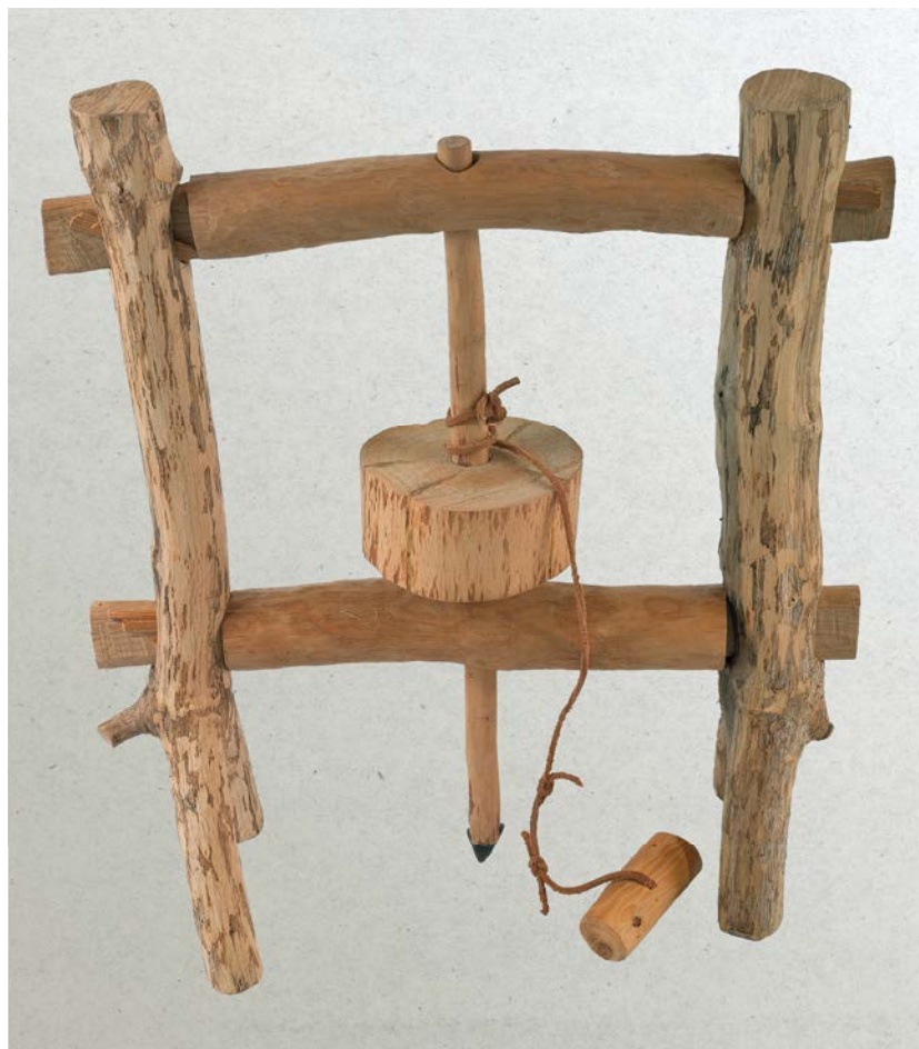
AFBEELDING 6. | Het principe van een grote boorinstallatie.
