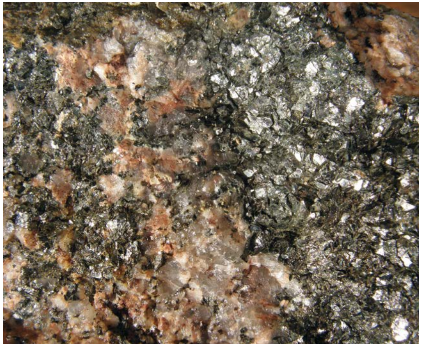
AFBEELDING 8. | Vers breukvlak van het graniet met biotiet en glimmer uit de stortbak. Het zwervende oeverblok uit de Oosterschelde (opgehaald uit een van de diepe putten) komt mogelijk uit België. Het betreft hier dan de zogenaamde eruptiva: graniet, tonaliet uit het Siluur(?).
