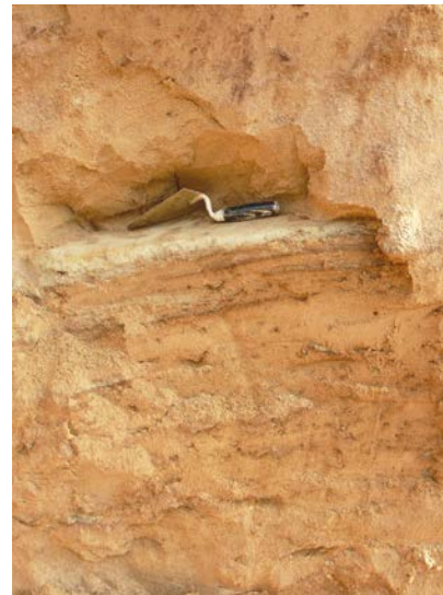
AFBEELDING 15. | Grijze keileemlaag van ca. 5 cm dik, bestaande uit zand en leem, met daaronder nog enkele zeer dunne keileemlaagjes gescheiden door zandlagen. De laag helt naar het oost-noordoosten. Soestdijkerstraatweg, Hilversum, oktober 2008.
