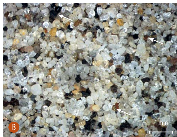
AFBEELDING 5. | A. Algemene plaat van de zilverzanden bij geringe vergroting. De goed afgeronde en gesorteerde kwartzanden zijn goed zichtbaar, evenals enige zware mineralen als magnetiet, pyriet en ijzeroxides. B. Vergroting van 5A met kwarts als dominant mineraal, met enige zware mineralen, zie onder 5A. Foto's: PanTerra
