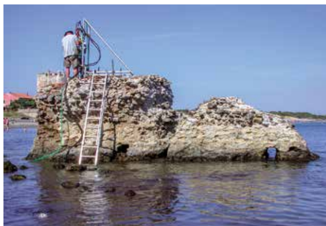
Afb. 4. In het kader van het onderzoekproject ROMACONS werd, met toestemming van Soprintendenza Archeologia per la Toscana, in 2003 een boring gezet in een Romeins kustverdedigingswerk in Portus Cosanus (Toscane). Foto: J.P. Oleson.
