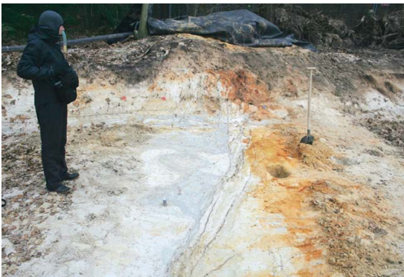
AFBEELDING 2. | TNO – Geologische Dienst collega Jeroen Schokker dient als schaal voor deze foto genomen van de vloer van de sleuf tijdens de eerste onderzoeksfase. Links is het hoge blok naast de breuk, rechts het gedaalde blok. Op het hoge blok zijn cryoturbate structuren zichtbaar, die door de breuk scherp worden afgesneden. De breuk bestaat uit een aantal min of meer parallelle takken. Op het lage blok is de neerslag van ingespoelde ijzeroxides in dekzand zichtbaar.
