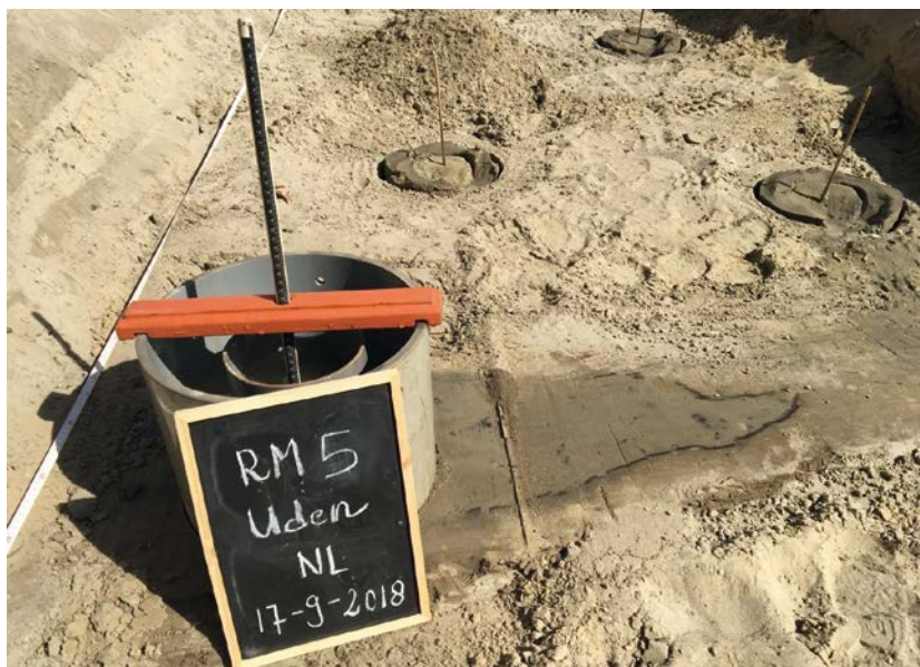
AFBEELDING 8. | In-situ meting (RM5) met de dubbele-ring-infiltrometer om de verticale doorlatendheid ( K_v ) van de Peelrandbreuk te bepalen (alle 12 metingen zijn in drievoud uitgevoerd).
