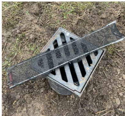
De trap van Enkamat werd zowel in een straatkolk (foto) als in een trottoirkolk getest. De constructie is erg gevoelig voor schade tijdens onderhoud en vuilophoping. (Foto: Raymond Creemers).
