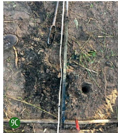
AFBEELDING 9. | Drie foto's van het intacte onderliggende bodemprofiel vanuit de smalle guts. Van links naar rechts het begraven mesotroofveen (9A: 126-183 cm), gevolgd door een kalkgyttja (9B: 191-241 cm) en het totale overzicht met de detritusafzetting in de basis (9C; 126-270 cm). Foto's: Erik Sonder en Gerry Bulten, Bosgroepen.
