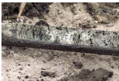
AFBEELDING 6. | Kalk die reageert met zoutzuur. Foto: Frits Kraefft.
