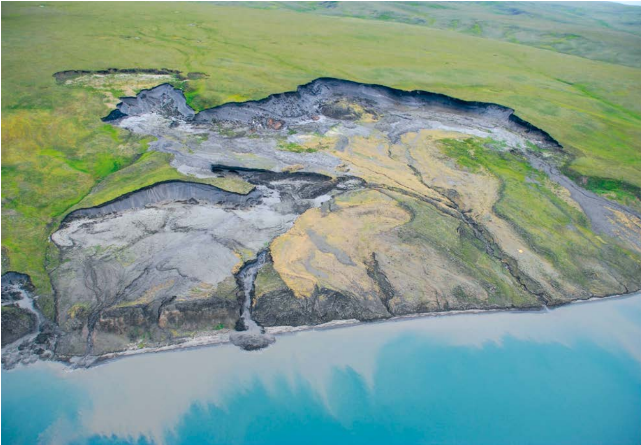
AFBEELDING 9. | Permafrostdooi en kusterosie op Herschel Island, voor de kust van de Yukon (Canada). De grond zakt ineen omdat ijs in de bodem smelt, en je ziet sediment via stroompjes de zee in verdwijnen. Foto: Hugues Lantuit
