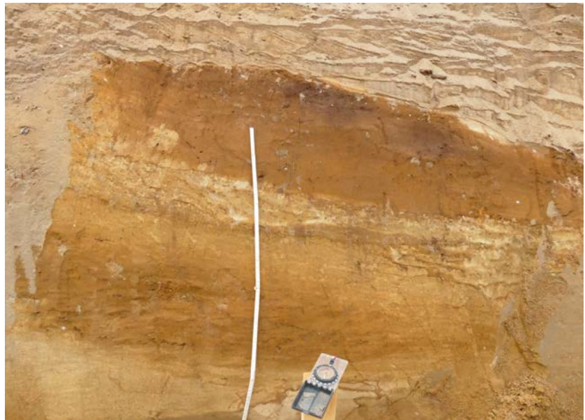
AFBEELDING 5. | Detail met boven de top van de meetlat de Bt-horizont, en een erosief contact met de bovenliggende fluvioglaciale afzettingen. Foto: Sander Koopman.
