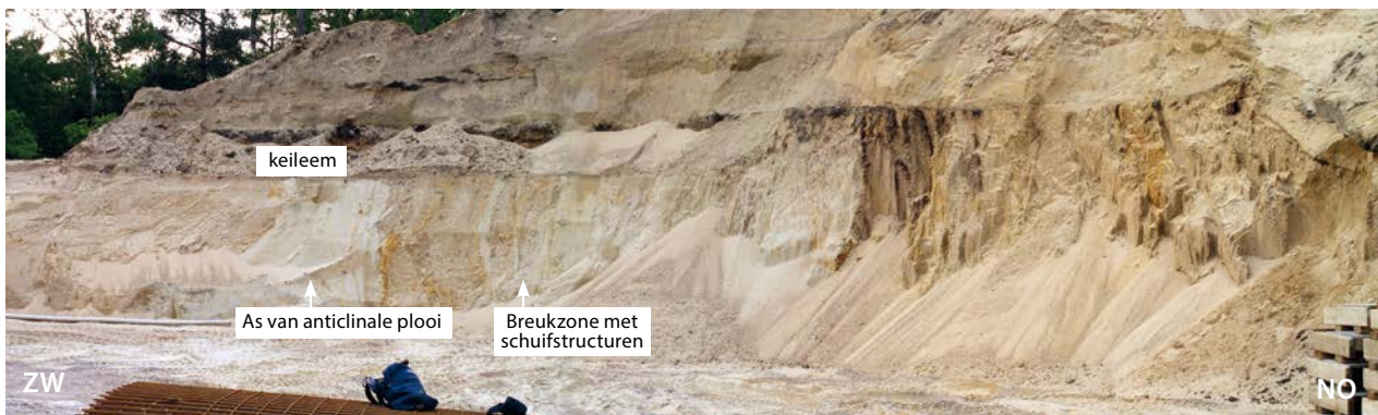
AFBEELDING 2. | Samengestelde foto van de profielwand naast het ecoduct over de A28 (locatie 1; coördinaten 151540/459320). Zichtbaar is een anticlinale structuur in sedimentpakketten van de Formatie van Urk met een breukzone in de oostflank (van Balen, 2006).
