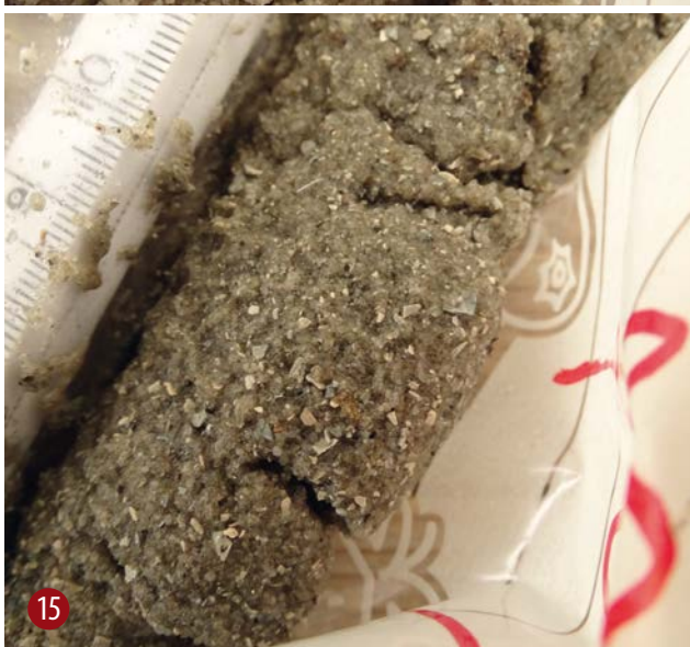
AFBEELDING 11. | Monster van 120 meter diepte, Formatie van Waalre. AFBEELDING 12. | Monster van 124 meter diepte met kleurovergang, deze markeert de overgang van de Formatie van Waalre naar de Formatie van Peize. AFBEELDING 13. | Monster van 153 meter diepte, Formatie van Peize. AFBEELDING 14. | Monster van 173 meter diepte, Formatie van Peize. AFBEELDING 15. | Monster van 189 meter diepte, met schelpfragmenten, Formatie van Maassluis. AFBEELDING 16. | Monster van 201 meter diepte, klei en silt, Formatie van Maassluis.
