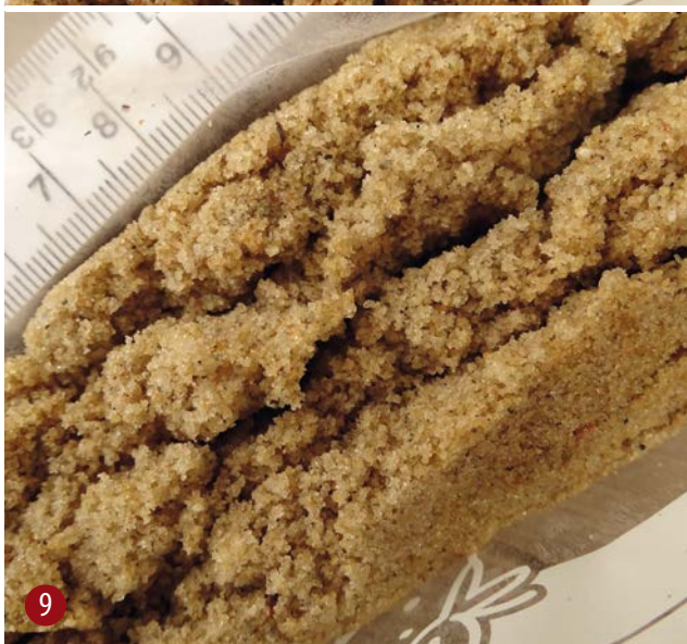
AFBEELDING 5. | Monster van 12 meter diepte, gestuwde afzettingen. AFBEELDING 6. | Monster van 32 meter diepte, met grind, gestuwde afzettingen. AFBEELDING 7. | Monster van 68 meter diepte, met kleibrokjes, overgang van gestuwde afzettingen naar de Formatie van Sterksel. AFBEELDING 8. | Monster van 72 meter diepte, met grind en kleibrokjes, Formatie van Sterksel. AFBEELDING 9. | Monster van 76 meter diepte, Formatie van Waalre. AFBEELDING 10. | Monster van 116 meter diepte, met grind, Formatie van Waalre.
