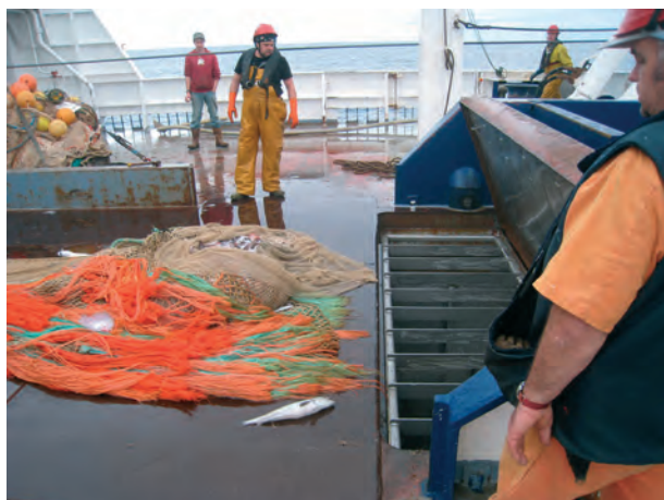
Fig. 3. De vangst wordt gestort in de vangstbak welke onderdeks uitmondt op een sorteerstraak. Daar gaat het via een jacobsladder naar een lopende band.
