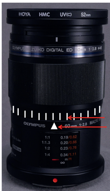
Afb. 7. Door merktekens aan te brengen, kan een grote nauwkeurigheid worden bereikt.
