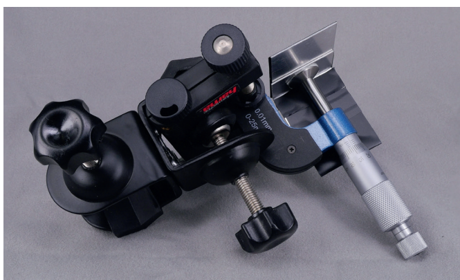
Afb. 17. Ombouw micrometer inclusief klem voor bevestiging.
