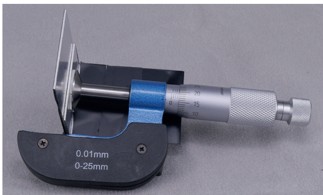
Afb. 16. Micrometer, 1 poot reeds afgezaagd om range te vergroten.
