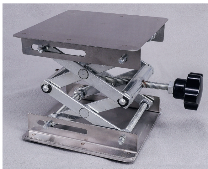
Afb. 20. Niet bruikbare laboratoriumtafel: bij het omhoog verplaatsen van de bovenkant heeft het geheel een te grote zijdelingse speling.
