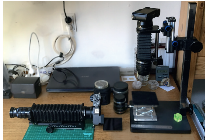
Afb. 3. Een verticale opstelling is veel stabiel dan een horizontale opstelling.
