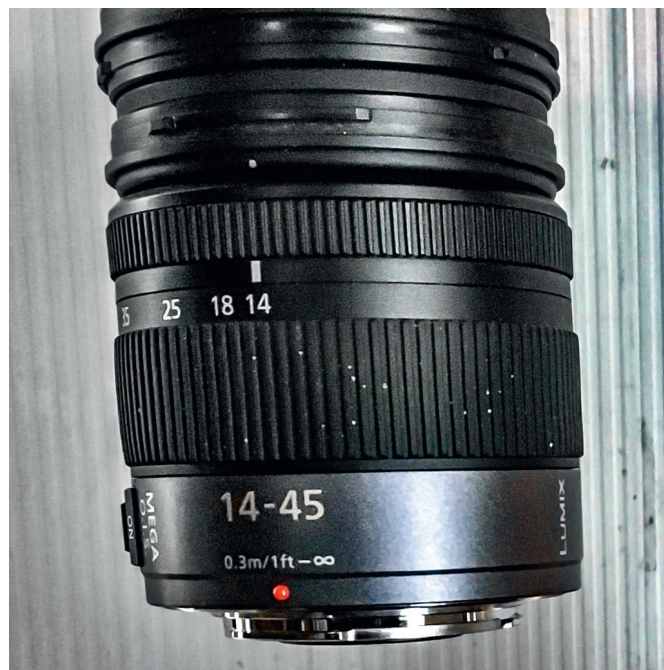
Afb. 15. De groothoeklens op 14 mm is de maximale vergrotingsmaatstaf = 14,28:1 (FOV 1,21 mm).
