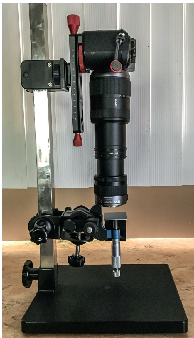
Afb. 12. De instelslede maakt het gemakkelijk een grof-instelling te maken van de instelafstand.
