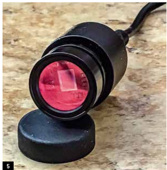
▲ Afb. 5. USB-insert komt op de plaats van het oculair.
