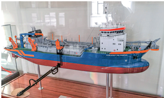
▲ Afb. 3. Schaalmodel van een sleeptopperzuiger. Let op de zuigbuis links die tot op de zeebodem reikt. Collectie: Nationaal Baggermuseum, Sliedrecht. (uit: Langeveld, 2017)
