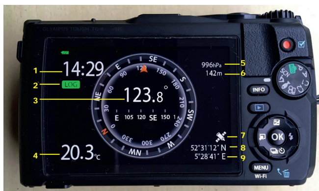
▲ Afb. 2. De gegevens op het logscherm: 1) Tijd; 2) Log opnemen wordt uitgevoerd; 3) Richtingsinformatie; 4) Temperatuur (of watertemperatuur); 5) Atmosferische druk; 6) Hoogte (of waterdiepte); 7) GPS aan; 8) Breedtegraad; 9) Lengtegraad;
