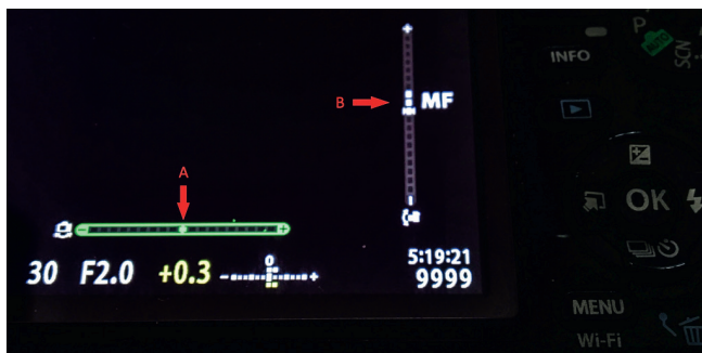
▲ Afb. 5. Horizontale en verticale afstembalken. Pijl A: Kader groen dus horizontaal is waterpas. Pijl B: Kader wit en twee rondjes boven midden dus camera niet verticaal.
