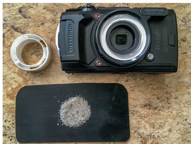
▲ Afb. 9. Hier het zand met behulp van het cellotape rolletje mooi bij elkaar gebracht. De camera kun je er met de lens precies overheen leggen.
