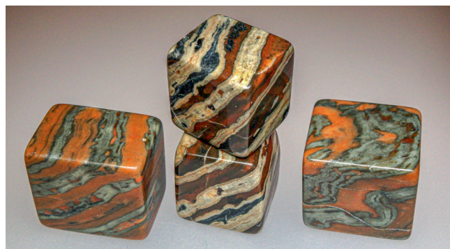
▲ Afb. 3. De verkiezelde tuf van Leipee in Rovaniemi is erg kleurrijk en taai. Deze nieuwe siersteen heeft de Finse handelsnaam "Lapin lumo" ("De charme van Lapland") gekregen. De kubussen op de foto zijn 15 mm breed en werden vervaardigd door Pohjanmaan Kivikerho. Foto © Kari A. Kinnunen, GTK.
