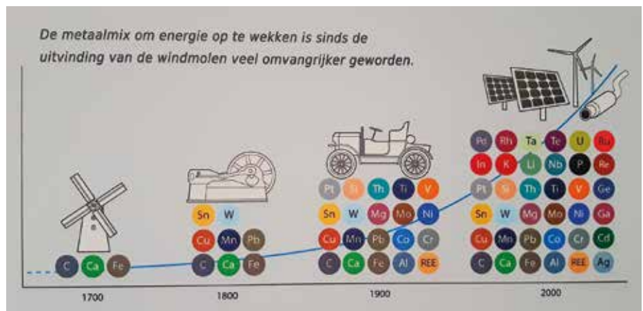
▲ Afb. 4. De mix van metalen om energie op te wekken of die zijn verwerkt in bijv. katalysatoren en ledlampen is sinds de uitvinding van de windmolen veel omvangrijker geworden. In windmolens werden alleen de chemische elementen C=koolstof in hout, Ca=calcium in de kalkmortel van gemalen schelpen en Fe=ijzer gebruikt. Foto: auteur.
