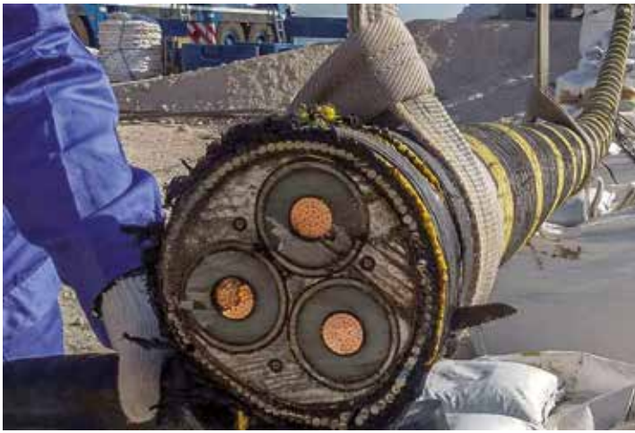
▲ Afb. 5. Dwarsdoorsnede van een onderzeese stroomkabel voor een windpark, die ca. 50 kg koper per meter bevat. De energietransitie vereist enorme hoeveelheden koper, waarvan het leeuwendeel moet komen uit landen als Indonesië, Chili en Peru, 's werelds grootste koperproducenten. Koper heeft de voorkeur vanwege zijn flexibiliteit en vermogen vibraties te doorstaan bij extreem weer. Aluminium is soms een goedkopere en betrouwbare vervanger. Bron: Energinet.
