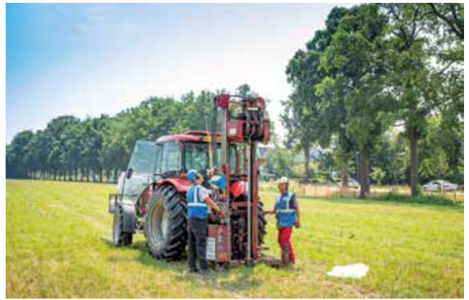
▲ Afb. 5. Schotgaten worden geboord voor het verzamelen van seismische data. In een schotgat wordt een seismische bron geplaatst, die geluidsgolven veroorzaakt. Aan het oppervlak vangen geofoons de teruggekaatste signalen weer op. Bron: EBN.
