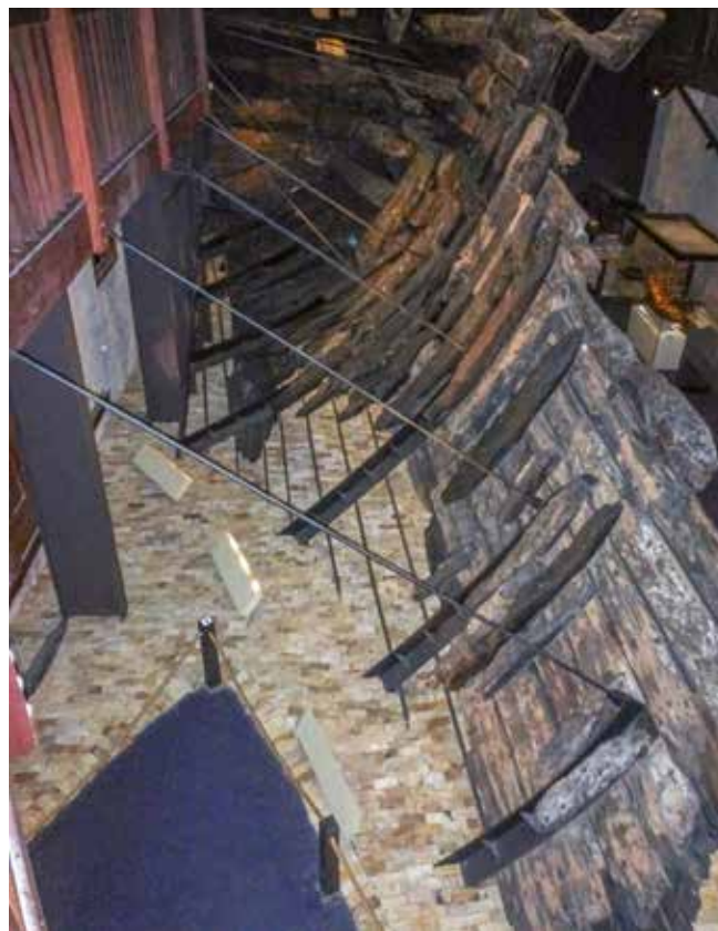
▲ Afb. 4. A. Schaalmodel en de van het wrakhout gereconstrueerde scheepsromp. ▶ B. Bovenaanzicht van de eiken scheepsromp. De VOC haalde voor de bouw van haar schepen het hout vooral uit Noord- en Oost-Europa. Archeologen stelden vast dat het hout voor het frame van de Batavia voornamelijk uit Nedersaksen kwam, terwijl de planken voor de romp werden gemaakt van hout uit het achterland van Lübeck en de Baltische regio. Foto's gemaakt in het Western Australian Shipwreck Museum in Fremantle door Kees de Jong.
