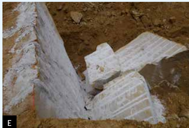
▲ Afb. D, E en F. Gebruik van cement dat in de loop van de tijd uitzet waardoor grote steenbrokken loskomen van de zandsteenbank.
