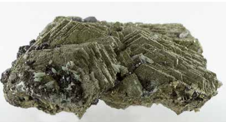
▲ Afb. 10. Pyriet, \text{FeS}_2 , pseudomorf na pyrrhotien, \text{Fe}_7\text{S}_8 , met galeniet en kwarts. De typische pseudo zeskantige vorm van de pyrrhotien bladen zijn volledige omgezet in pyriet. Vindplaats: Herja Mijn, Baia Mare, Maramures, Roemenië. Breedte specimen: 7 cm.
