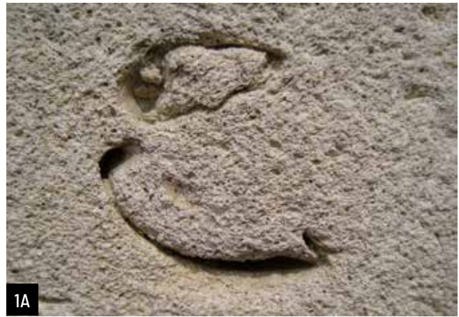
▲ Afb. 1A. Macroscopisch detail van een stuk oölitische Savonnières-kalksteen met opvallende schelpgeesten (opgeloste fossiele schelpen van bivalven). Sint-Brigidakerk in Noorbeek, Zuid-Limburg, Nederland.
