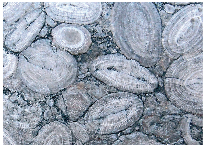
Afb. 6. Deelvergroting van een andere traptrede. Foto om de vergroeiingsrelatie tussen nummulieten onderling te laten zien. Door oplossing van kalk onder verhoogde druk zijn delen van de kalkschalen opgelost, waarbij een onoplosbaar kleilig residu de vergroeiingsnaad markeert.
