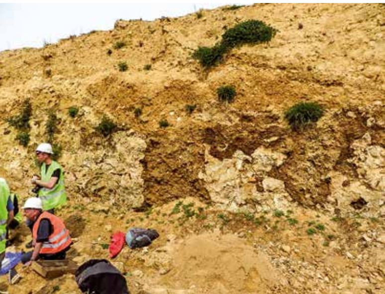
Afb. 8. Twee duidelijk zichtbare orgel- of aardpijpen in de kalksteenwand (Emael Member). Foto: M.J.M. Deckers.
