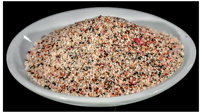
Afb. 4. Monazietzand. Het mineraal monaziet kan veel thorium bevatten en dan voor een aanzienlijke stralingsbelasting zorgen. Foto: Th.W. Gray.
