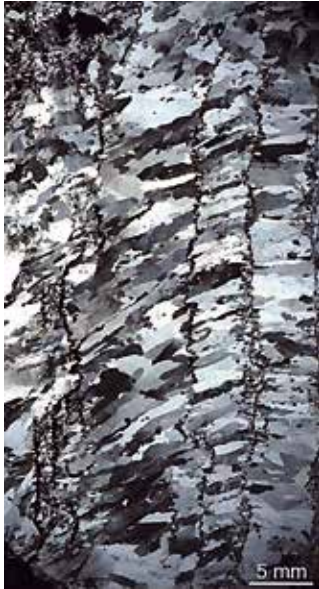
Afb. 3. Onder de petrografische microscoop wordt duidelijk hoe de kwartskristallen de opengaande spleet of verschuivende breuk hebben opgevuld. Dit is een voorbeeld van een fibreuze aderopvulling, die het resultaat is van een 'crack-seal' proces.
